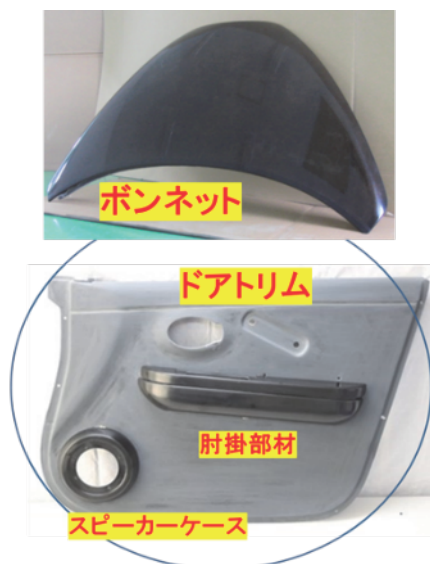
図1 繊維強化リグニン材を用いた自動車部材試作品 （左：自動車部材を実装した自動車、右：実装した自動車部材）
