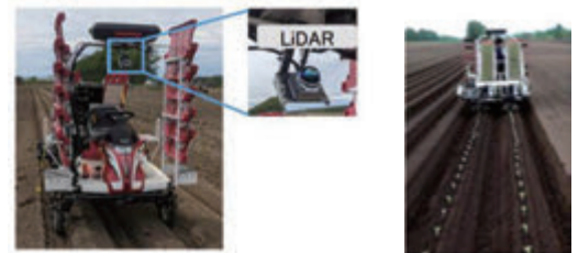
LiDAR畝検出に基づく精密定植
