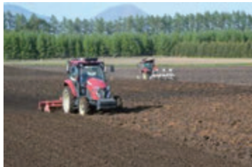
リバーシブルプラウとロータリハローの同時無人作業
