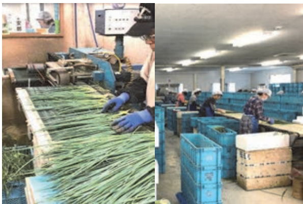
図4 従来の調製機を用いた調製作業 (投入:1名、再調整:7名)
