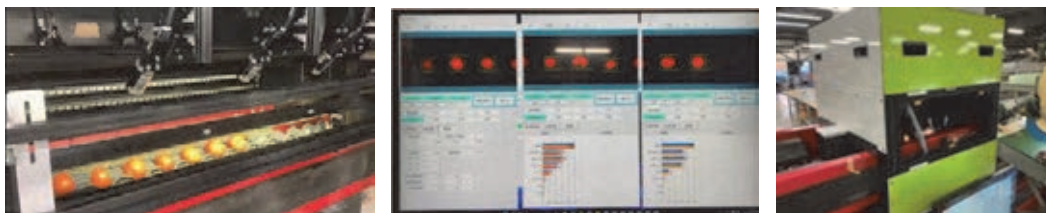
いわき小名浜菜園(株)に設置したAI選果機 (左:選果機内に設置された照明・カメラ 中央:AIによる判定画面 右:内部品質センサー)
