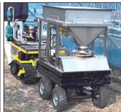
図3 施肥アタッチメント 性能: ホッパ容量114.4L、4WS操舵 作業効率: 実証評価中
