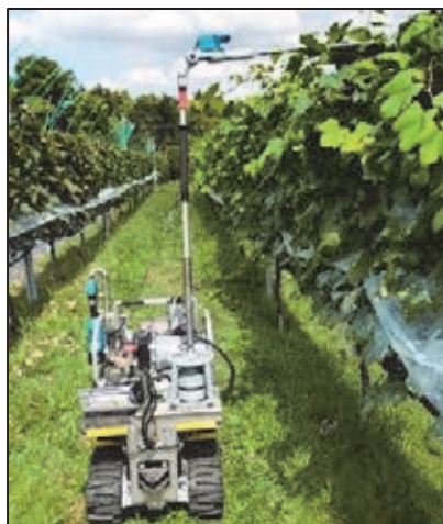
図5 剪定アタッチメント 性能: 刈込幅500mm、6段階角度調整 作業効率: 実証評価中
