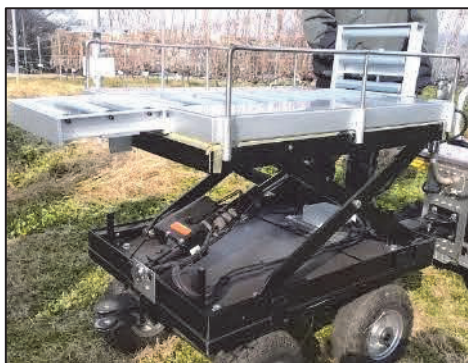
図1 収穫・運搬アタッチメント 性能: パッシブステア・昇降機能搭載 作業効率: 労働時間約30%削減(推定)
