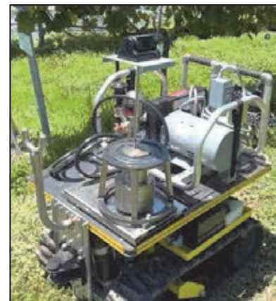
図6 監視(※)アタッチメント 性能: フルHDカメラ、IP69K 作業効率: 実証評価中 ※カメラ・センサを用いて果樹画像を取得・解析し、生育状態を監視する。
