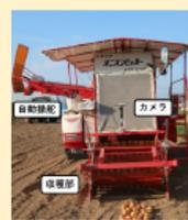
玉ねぎの自動収穫機 (試作機)
