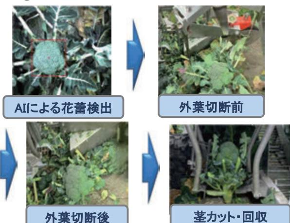
作業能率1.65h/10a、収穫精度96.4%
