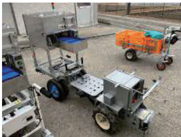
選果ユニットを搭載した電動収穫台車(左: 乗用型; 右: 歩行型)
