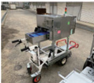
選果ユニットを搭載した電動収穫台車(左: 乗用型; 右: 歩行型)
