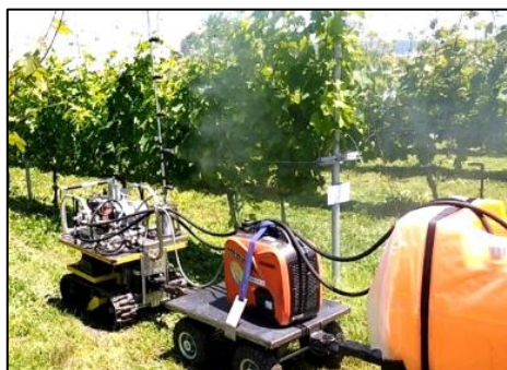
図4 防除アタッチメント 性能: 薬液タンク200L、最高圧力3.5MPa 作業効率: 実証評価中
