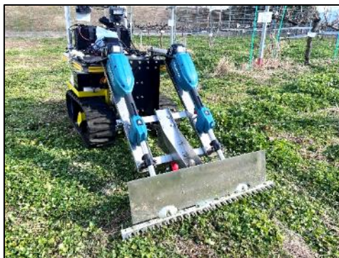
図2 除草アタッチメント 性能: 刈込幅660mm、AI人検知警報 作業効率: 実証評価中
