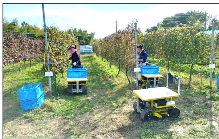
図7 収穫作業時の小型電動ロボットの複数台同時運用
