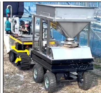
図3 施肥アタッチメント 性能: ホッパ容量114.4L、4WS操舵 作業効率: 実証評価中
