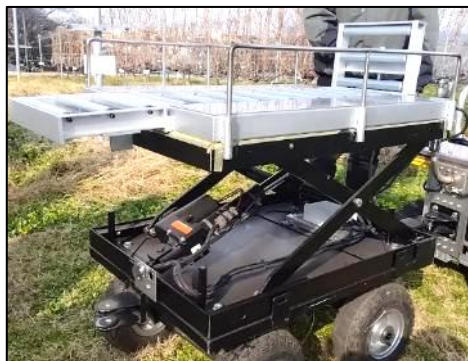
図1 収穫・運搬アタッチメント 性能: パシプステア・昇降機能搭載 作業効率: 労働時間約30%削減(推定)
