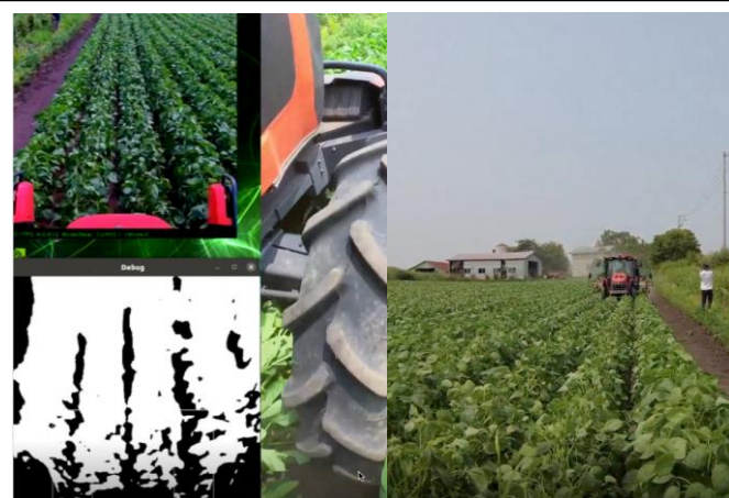
② トラクタを畝に沿って走行 認識結果を操舵制御に利用
