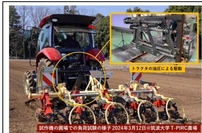
作業機の横ずれを補正 油圧スライドリンクでカルチベータ位置を調整
