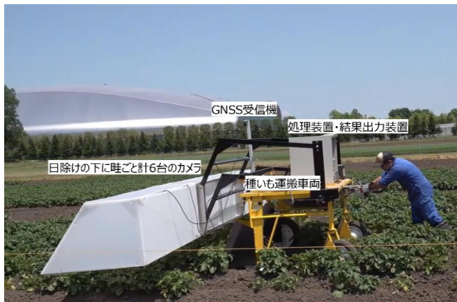
試作機(ほ場管理車両型)の構成 (最大6畦の同時判定が可能)
