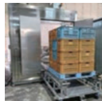
1トンの種イモを処理できる蒸熱処理機
