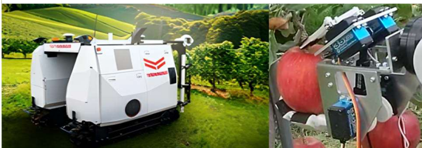
下段： 自動走行車両と 搭載されるハンド
