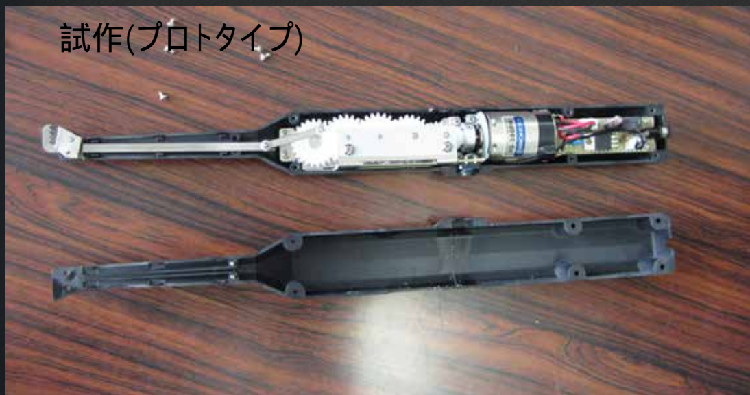
写真1 省力機器の概要(摘果器具(デモ機)) (設計書をもとにデモ機を製作)
