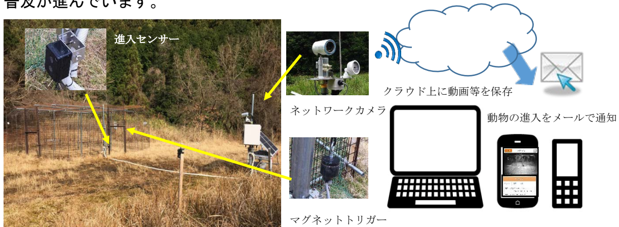
図1 開発した「クラウドまるみえホカクン」のシステム概要
