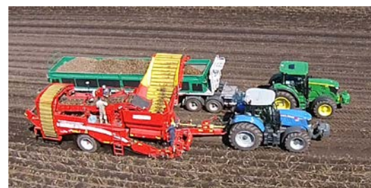
写真4. 2 畦収穫機からトレーラへ直接排出する収穫作業の様子
