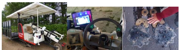
写真6. 改良したキャベツ収穫機（左）とバックモニター（中）、姿勢制御機構（左）
