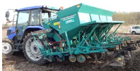
写真3. バレイショの施肥・播種・培土の一工程化作業の様子
