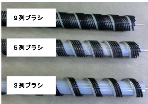
写真6 葉切り部のブラシロール
