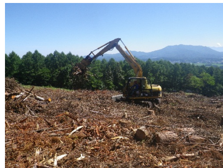
写真 1 高性能林業機械を用いた主伐（左）と、それに続く地拵え（上）
