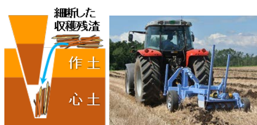
図 2. カットソイラの模式図（左）と作業の様子（右）
