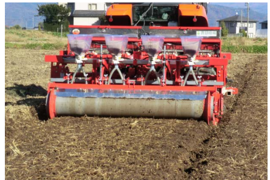
図 1 ダウンカットロータリを利用した 新たな耕うん同時畝立て播種機
