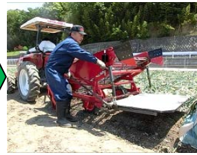
手動式レバーで荷台を上げ油圧をロックする
