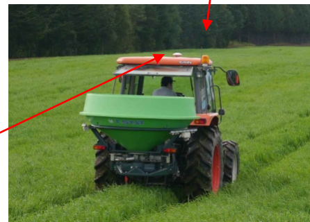
図3 マップの数値に従い、ポイントごとに施肥量を変えながら散布
