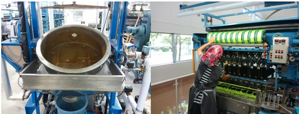
写真1 試作した真空式煮繭機と蛍光繭の繰糸状況
