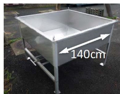
図3 クラゲ類排出装置Ⅱ型 (船上に設置するタイプ)
