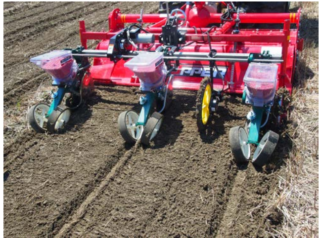
写真3 大豆一工程播種 ※天候に左右されにくいことから適期播種が可能
