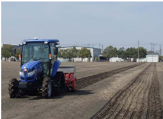
写真1 GPS自動操舵トラクタによる大画面圃場でのV溝直播
