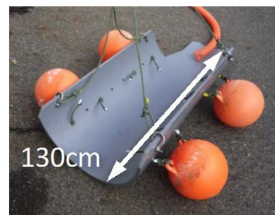
図2 クラゲ類排出装置Ⅰ型 (網内に浮かべるタイプ)
