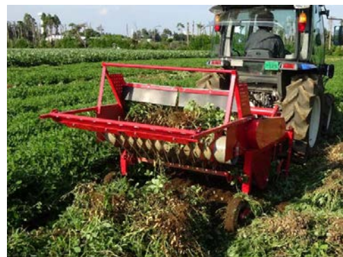
図2 ラッカセイ収穫機
