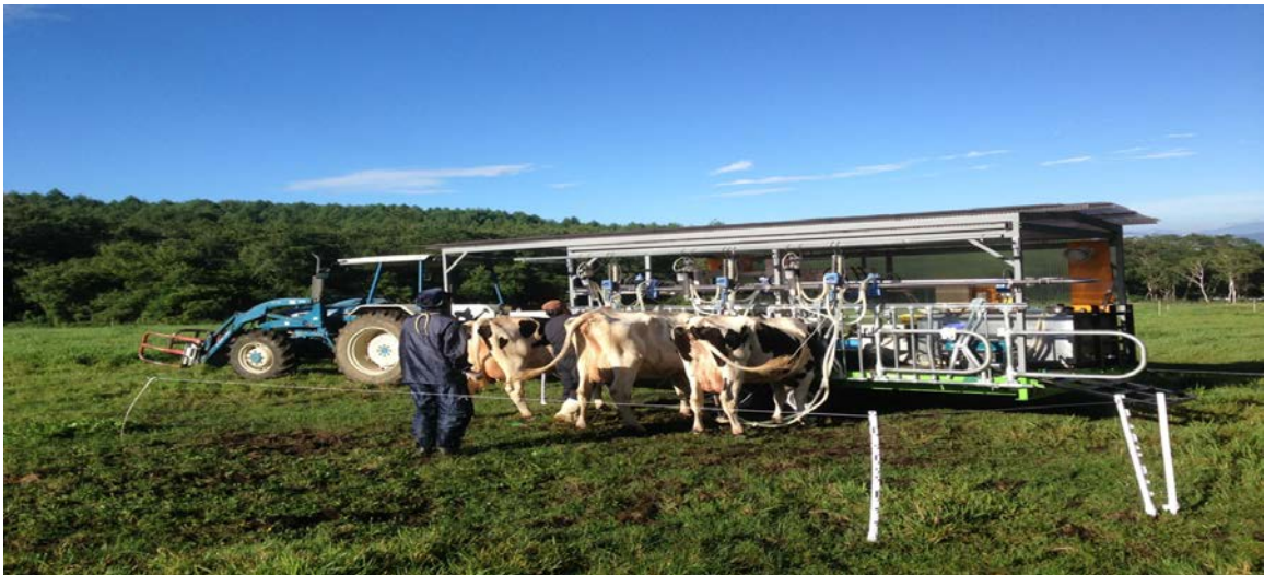
写真1 日本型移動式搾乳機（MMP）（特願 2015- 207952）
