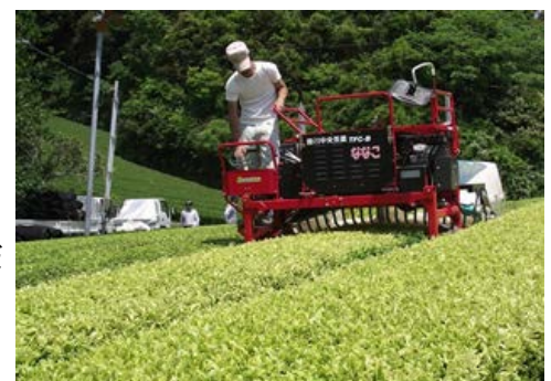
写真1 茶園局所施肥機 茶樹の樹冠下の土壤に緩効性肥料を打ち込み施肥作業回数を削減
