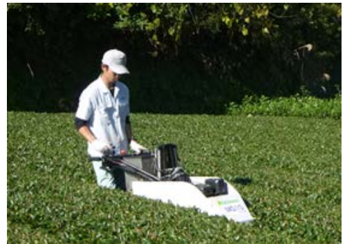
写真1 茶園局所施肥機 茶樹の樹冠下の土壤に緩効性肥料を打ち込み施肥作業回数を削減
