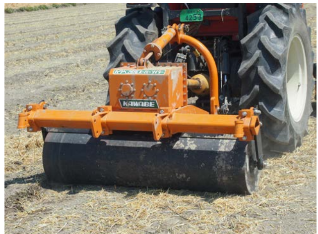
写真2 振動鎮圧による漏水防止 ※麦作後でも乾田直播栽培が可能
