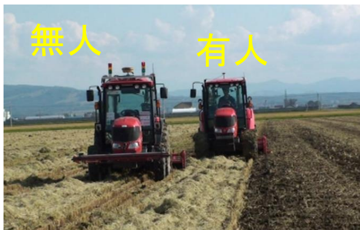
写真2 ロボットトラクタ(105馬力)による2台協調耕うん作業
