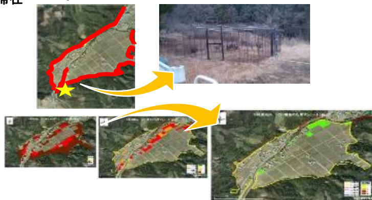
図13 防護柵と併せた集落での被害軽減効果 防護柵（赤ライン）設置が進んでいる集落で、道路や河川などのシカの進入路で集中的に捕獲することで、被害は大幅に軽減できた
