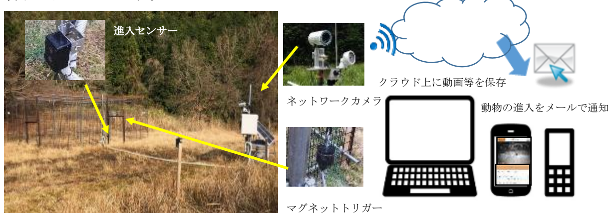
図1 開発した「クラウドまるみえホカクン」のシステム概要
