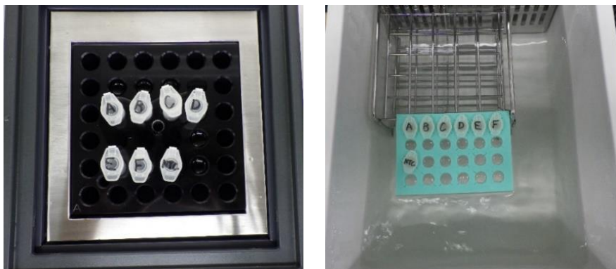
図5 LAMP 反応の様子。ブロック恒温槽の場合はウェルに水を入れる（左）、恒温水槽の場合はフローター等を使用する（右）。
