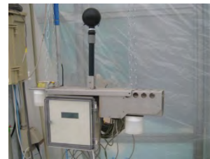
図1 労務管理への活用が可能なUECS対応WBGT測定装置
