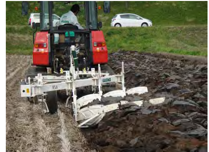
ジョインタ付きプラウによる水田の反転耕
