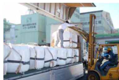
簡易荷役具を活用したロール型発酵TMRの荷積み
