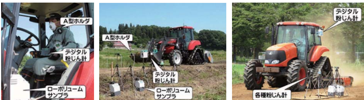
粉じん測定状況
