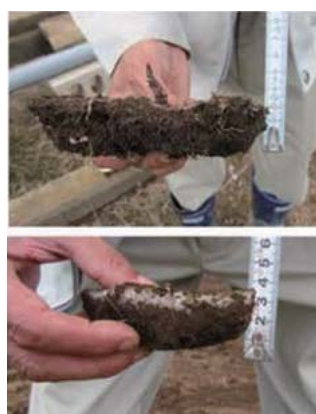
固化剤の吹きつけ作業と固化後の状況
