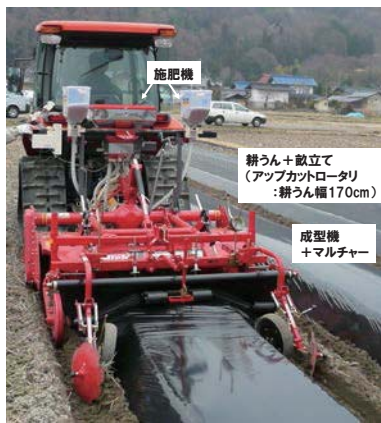
耕うん同時畝立てマルチ作業機
