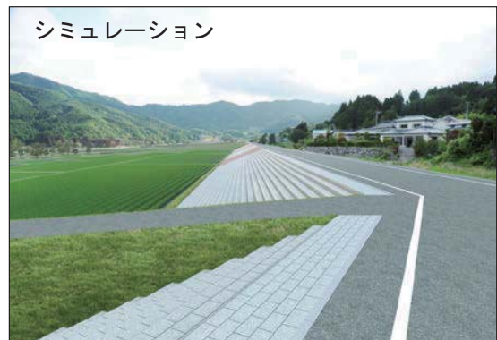
シミュレーション 住宅と農地の間に第2堤防兼集落道を整備する
