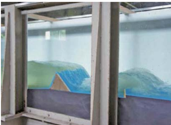
水理模型実験による津波減勢効果の検証
