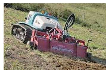
開発したロータリを無線傾斜地トラクタに装着して耕うんする様子（傾斜 20\sim 24^{\circ} 草地）
