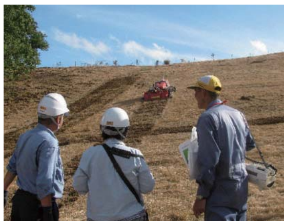
開発したロータリを装着した無線傾斜地トラクタによる急傾斜地草地の耕うん作業講習会
