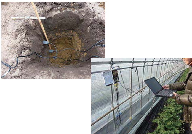
センサー設置状況と観測データ回収の様子
