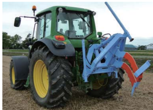
穿孔暗渠機「カットドレーン」の外観
