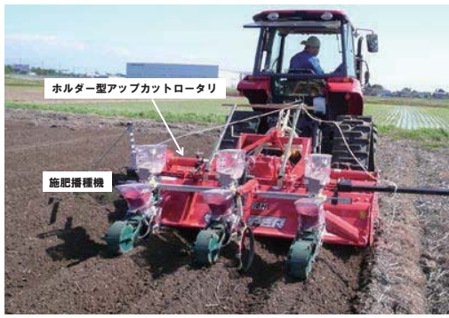
ダイズの耕うん同時畝立て播種作業機 (75cm 畝)
