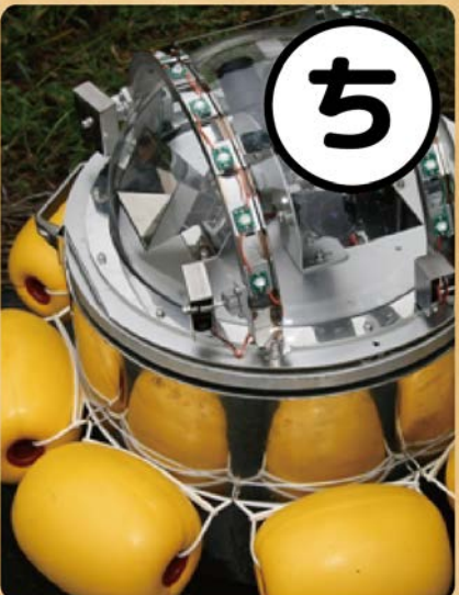
のうぎょうよう すいろ 農業用水路トンネル むじんちょうさ 無人調査ロボット
