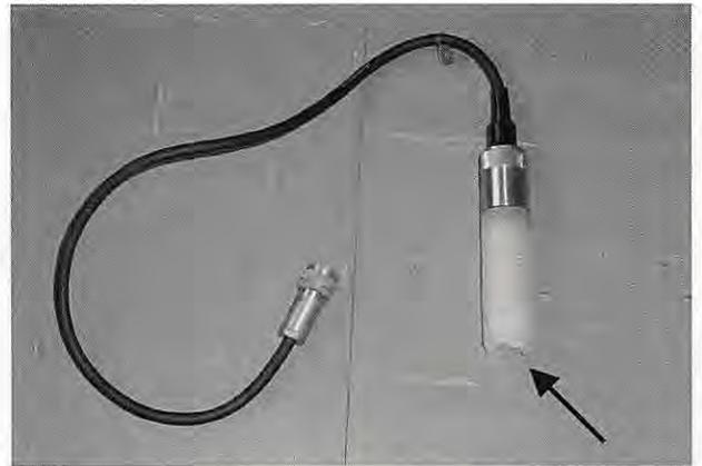
図2 観測に使用したガラス電極式CO<sub>2</sub>センサー
