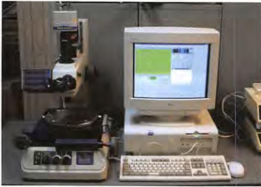
写真IV-1 玄米の粒長・幅測定顕微鏡
