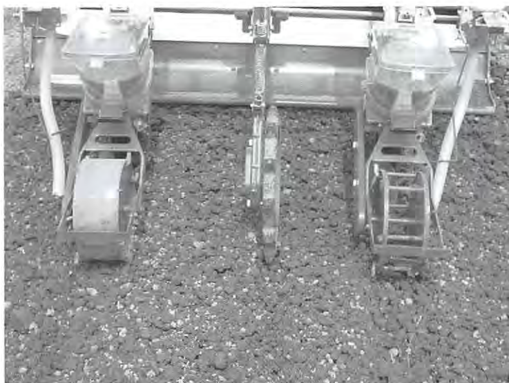
写真2 鎮圧の影響を検討するために用いた播種機鎮圧ローラーの形状
