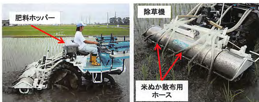
図1 高精度水田用除草機による機械除草同時米ぬか散布作業
