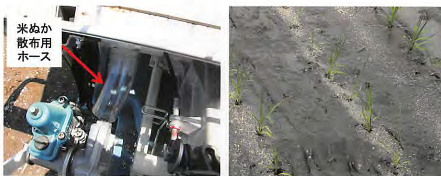
図2 田植ユニットの改良 (左) と移植同時米ぬか散布の状況 (右)
