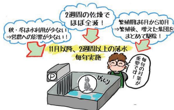
図7. 貯水池落水によるカワヒバリガイの駆除
