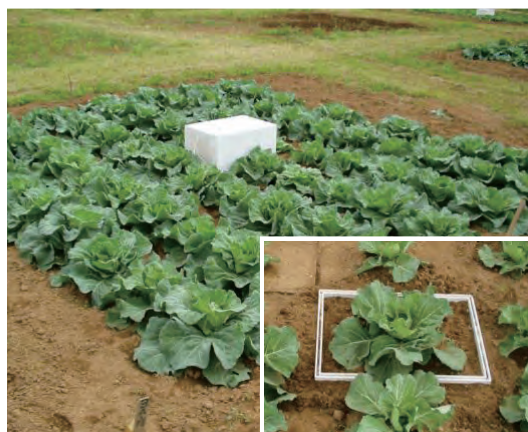
図 3 クローズドチャンバー法によるキャベツ圃場からの N_2O 発生量の測定の様子
