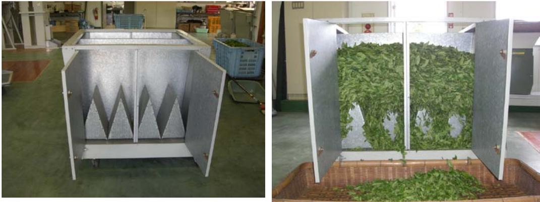
写真1 青枯れ防止板(通風コーン)8個使用状況 (左：設置状況、右：生葉充填状況、片側4個、両側にある)
