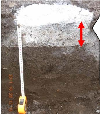
深さ 10cm まで低密度の低い土層があり、表層部に水が停滞する。水性ペイント溶液では水より粘性が強く下層への浸透は少ない。
