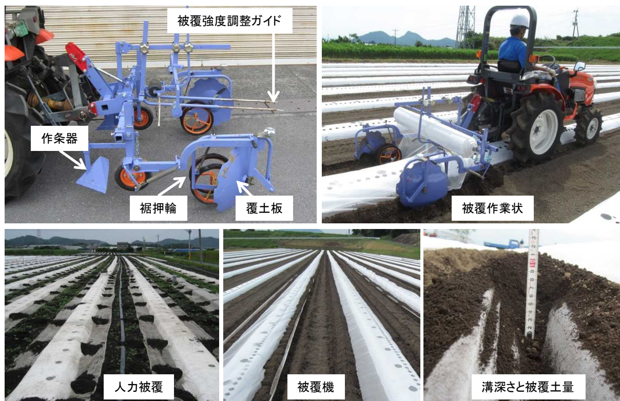
図1 寒冷紗被覆機の構造と作業状況
