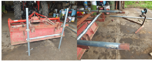
(A) 単管パイプの先端にL字溝を溶接し、ロータリに装着（作業量：22.5 分/a）
