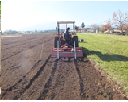
(A) 単管パイプの先端にL字溝を溶接し、ロータリに装着（作業量：22.5 分/a）
