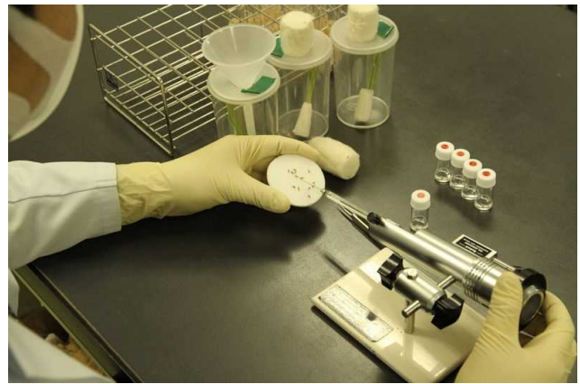
図2 微量局所施用法の検定作業 炭酸ガスで麻酔した供試虫に、微量局所施用装置を使ってアセトンに溶かした殺虫剤薬液を1頭ずつ塗布する。
