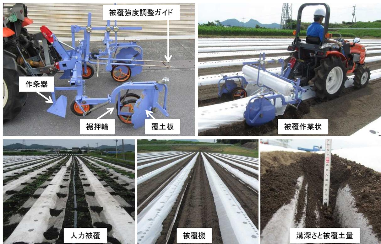
図1 寒冷紗被覆機の構造と作業状況
