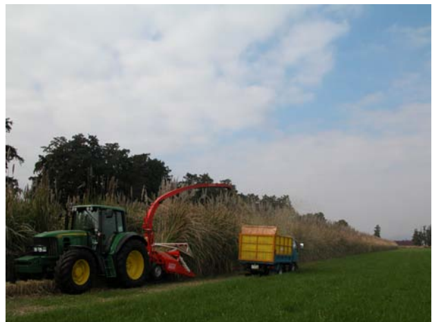
写真2 エリアンサス「JES3」の機械収穫 立型の草姿であるため、効率的な機械収穫が可能である。毎時収穫量は乾物17.6トン、生重45.3トンを達成できる。 平成23年12月9日撮影 九州研(合志市)
