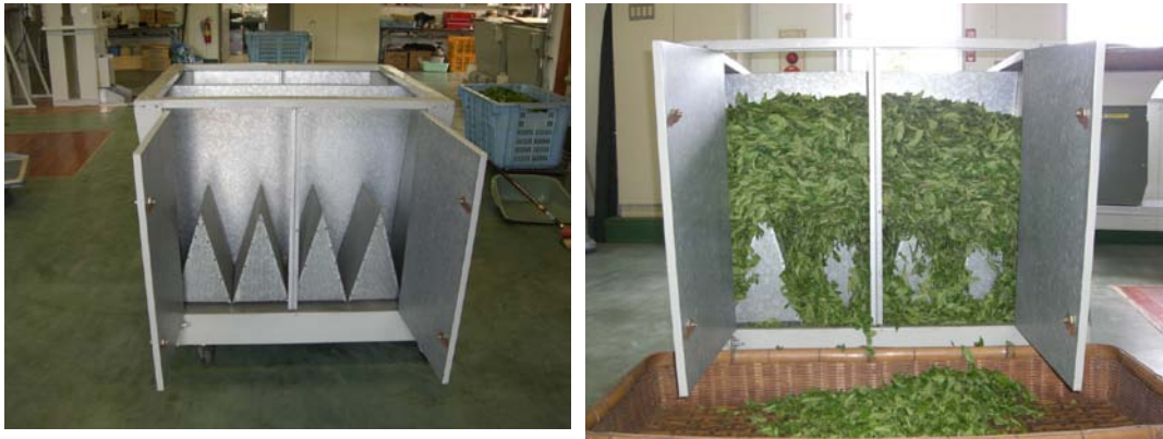
写真1 青枯れ防止板(通風コーン)8個使用状況 (左：設置状況、右：生葉充填状況、片側4個、両側にある)
