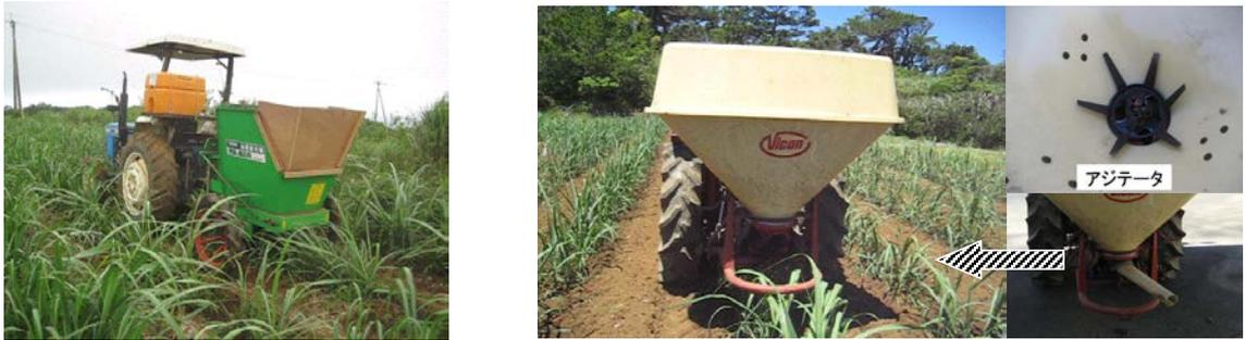
(左：堆肥条散布機〈MS-60〉 右：散布筒揺動型ブロードキャスタ〈アジテータ装着・散布筒取り外し〉)
