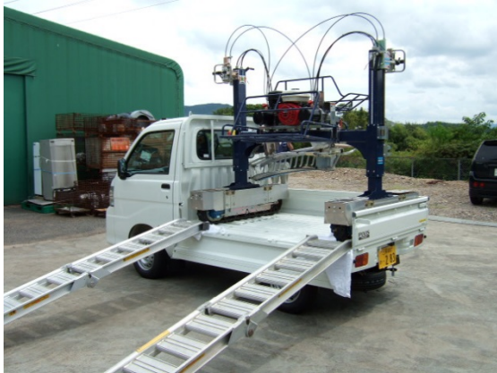
写真1 開発した自走式茶園管理機（左：軽トラック積載状態、右：茶園での作業状況）
