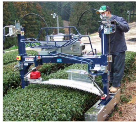
写真1 開発した自走式茶園管理機（左：軽トラック積載状態、右：茶園での作業状況）
