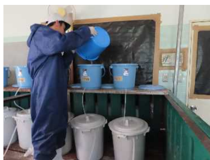
図2 試験排水を使ったリン吸着試験の状況およびリン除去率 (全リン) の変化
