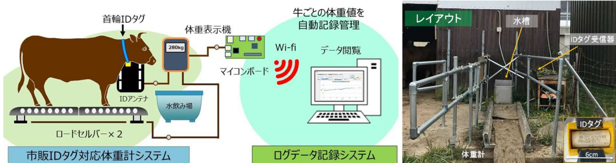
図1 自動体重計測システムの模式図と当所のレイアウト
