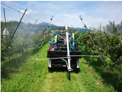
カキジョイント栽培の自動走行車を活用した自動防除
