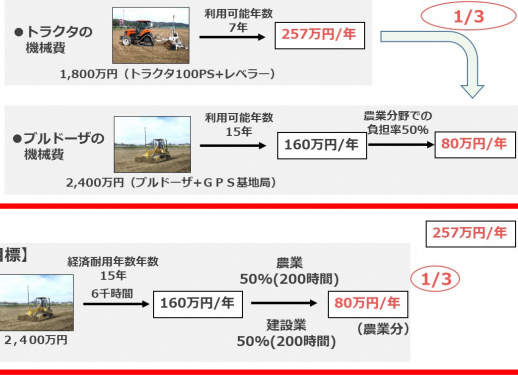
図4 農業分野に係る機械費がトラクタ利用に比べ1/3となる活用モデル ※農業ブルドーザの適正な利用時間は年あたり200時間であり、作付け面積では50haに相当する。
