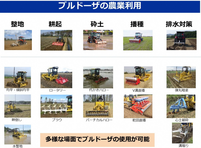
図3 水田、畑作業において農業ブルドーザで作業可能な作業機
