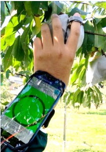
図4 圃場利用型振動装置で、樹上でのモモの内部障害や熟度判断へ音響振動法を応用
