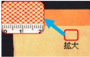
図1 開発された機能性果実袋における酸化チタンの塗布方法
