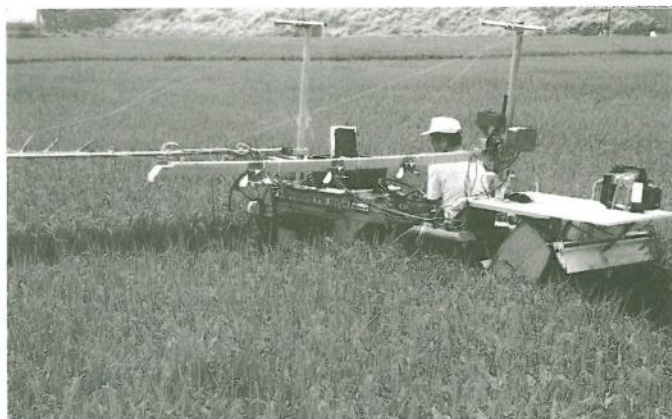
図6 分光装置搭載の自動施肥機圃場テスト風景
