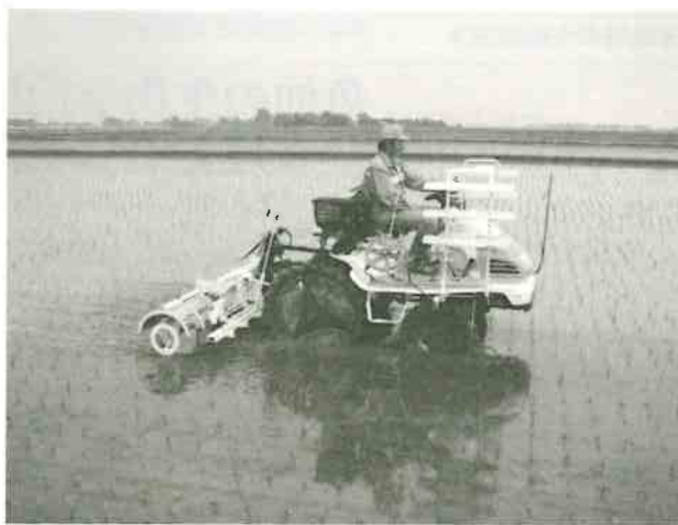
図3 開発機による除草作業の状況(宮城県中新田町) (平成14年5月25日 除草作業1回目)
