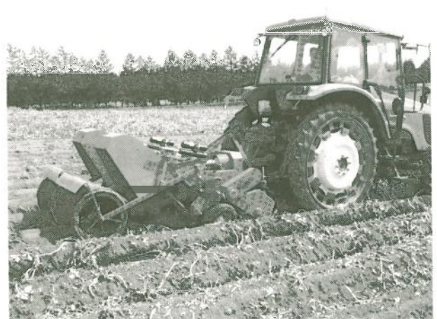
図1 いも類の収穫前茎葉処理機(左:自走式,右:トラクター装着式)
