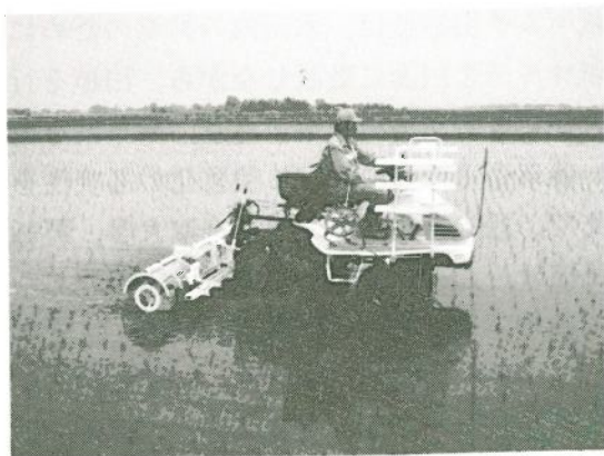
図1 高精度水田除草機による作業風景 （宮城県，2002年5月）
