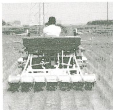
図4 高精度水田用除草機を用いた機械除草・米糠同時散布作業 (生研センター附属農場, 2006年6月)
