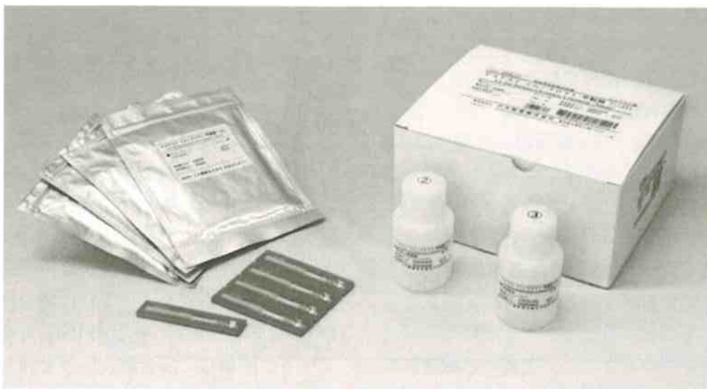
図3 イムノクロマトキットの試薬構成
