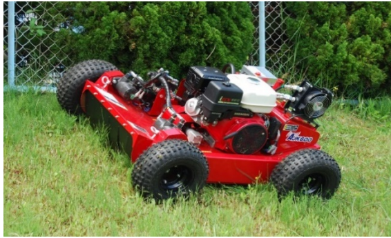
急傾斜地で作業するリモコン草刈り機
