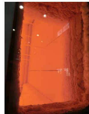
写真 1：耐火試験の様子。 試験中の炉内温度は加熱開始 2 時間後に約 1050℃に達します。
