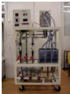
電気浸透隔膜法によるラクトフェリン製造機
