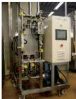
限外濾過膜法によるアポラクトフェリンの製造機
