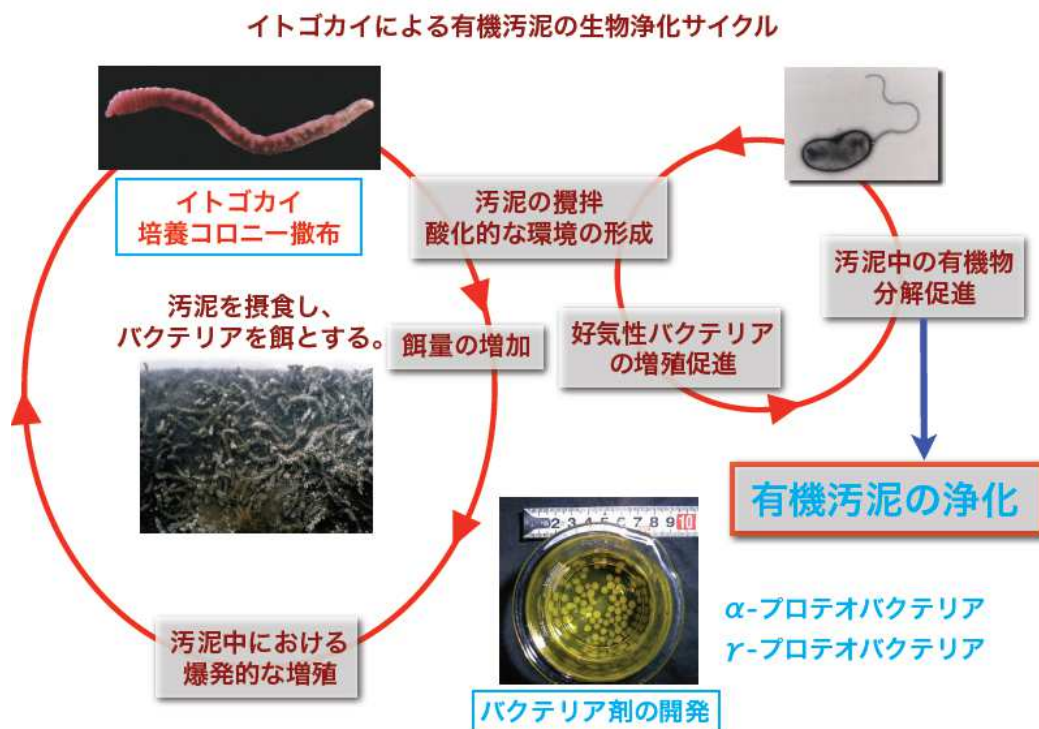
図 3-14 イトゴカイによる有機汚泥中の有機分解促進のメカニズム（バクテリアとの協働）
