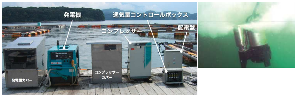
図 3-13 開発したマイクロバブル発生システム（右）、 水中でマイクロバブルを放出するマイクロバブル発生装置
