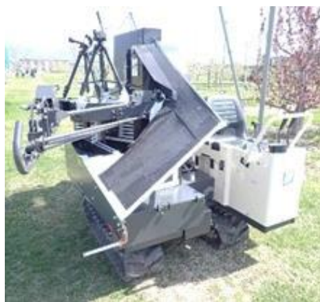
開発中の自走式花蕾採取機 (試作5号機)
