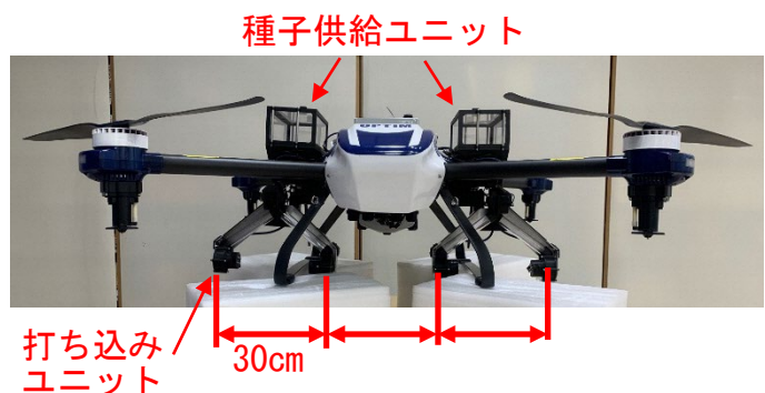
図 2 開発した播種機を自動飛行ドローンに 装着した状態
